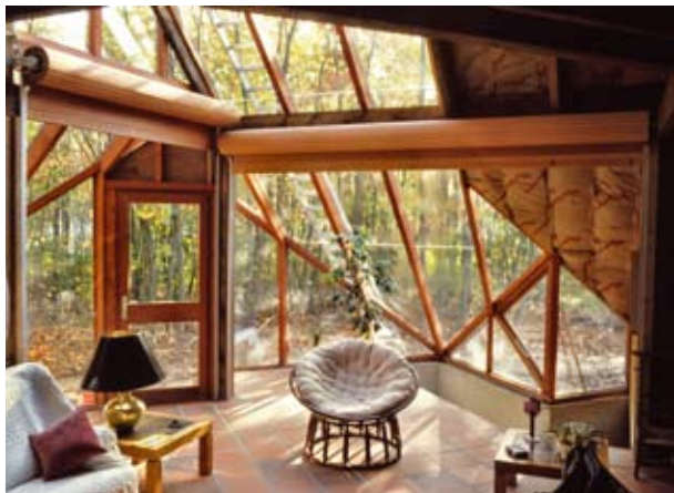
Cette véranda est plus efficacement protégée des surchauffes par son environnement boisé que par ses stores intérieures.
